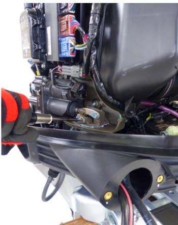
3. Insérez le tournevis cruciforme avec manche de la trousse à outils dans le trou de l'articulation de changement de vitesse.
