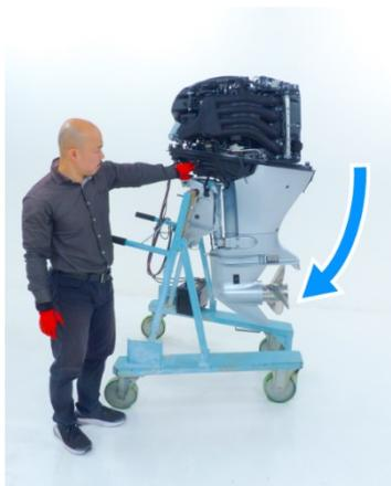
5. Inclinez le moteur hors-bord vers le bas en position verticale et laissez le séparateur de vapeur terminer la vidange.
