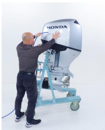
1. Rincez le moteur hors-bord à l'eau douce pour éliminer l'eau de mer, le sable, la boue, etc. Déposez le capot moteur et rincez également l'intérieur du capot moteur.
